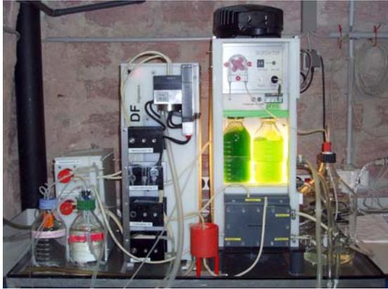
Abb. 1.3.11: Algentest an seinem Standort in der RGS. Aufstellung von links nach rechts: Add-on für den täglich durchgeführten Empfindlichkeitstest mit Atrazin, Messgerät, Algenhälterung, Flasche mit Nährmedium für die Algen
