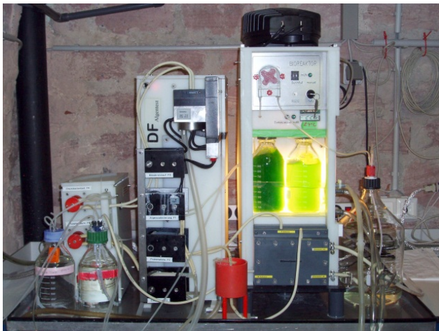
Abb. 1.3.14: Algentest an seinem Standort in der RGS. Aufstellung von links nach rechts: Add-on für den täglich durchgeführten Empfindlichkeitstest mit Atrazin, Messgerät, Algenhälterung, Flasche mit Nährmedium für die Algen
