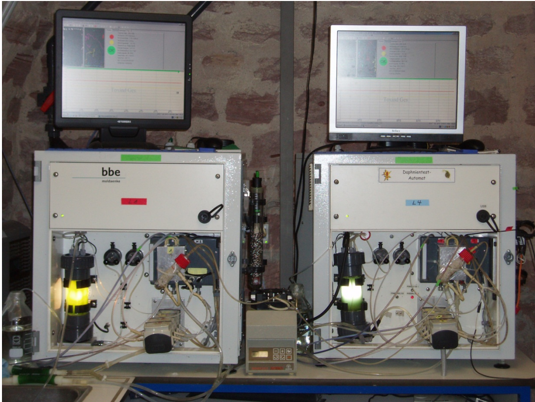
Abb. 1.3.9: Im Winter 2012/2013 wurde zum ersten Mal seit Beginn der Messungen in Worms eine Zufütterung mit Algen unverzichtbar. Die Abbildung zeigt beide Daphnientoximeter der RGS mit der in Betrieb befindlichen Algenzufütterung.
