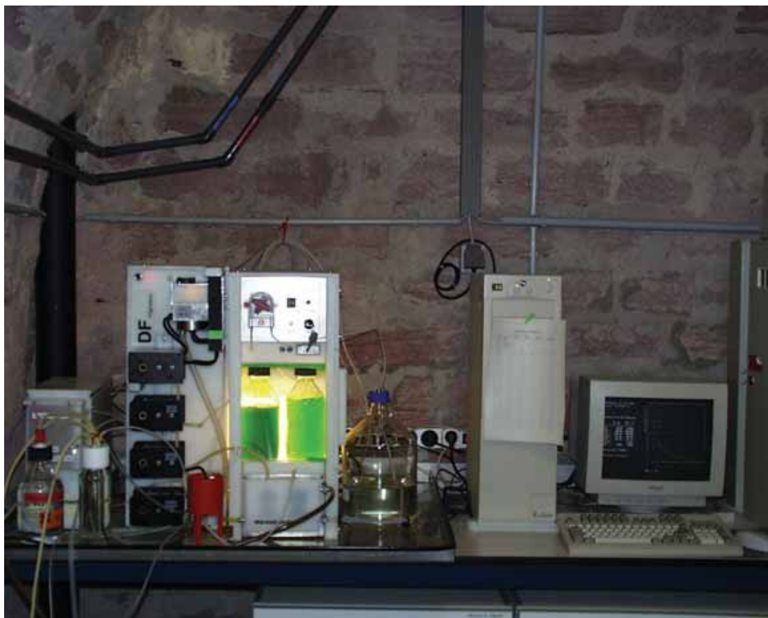
Abb. 1.3.13 Algentest an seinem Standort in der RGS Aufstellung von links nach rechts: Add-on für den täglich durchgeführten Empfindlichkeitstest mit Atrazin, Messgerät, Algenhälterung, Flasche mit Nährmedium für die Algen, PC zur Aufzeichnung und Auswertung der Daten)
