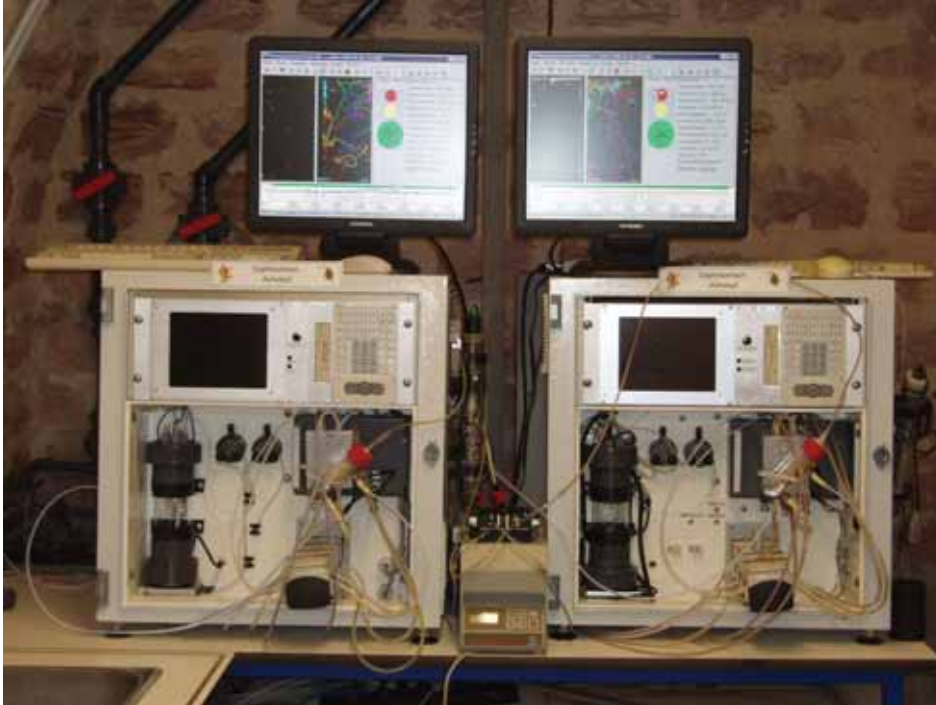
Abb. 1.3.9: Die zwei neuen bbe Daphnientoximeter der Rheingütestation Worms an ihrem Standort im Gewölbe.
