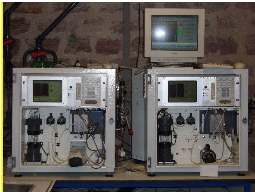
Abb. 1.3.14: Die bbe-Daphnientoximeter an ihrem Standort in der Rheingütestation. Inbetriebnahme für die Routineüberwachung zum 01.01.2007.
