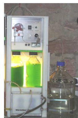
Bioreaktor des DF- Algentests
